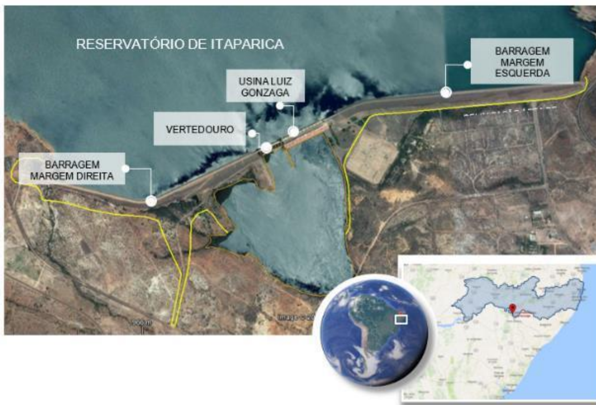
FIGURA 3.3 – ARRANJO GERAL DA USINA HIDRELÉTRICA LUIZ GONZAGA
