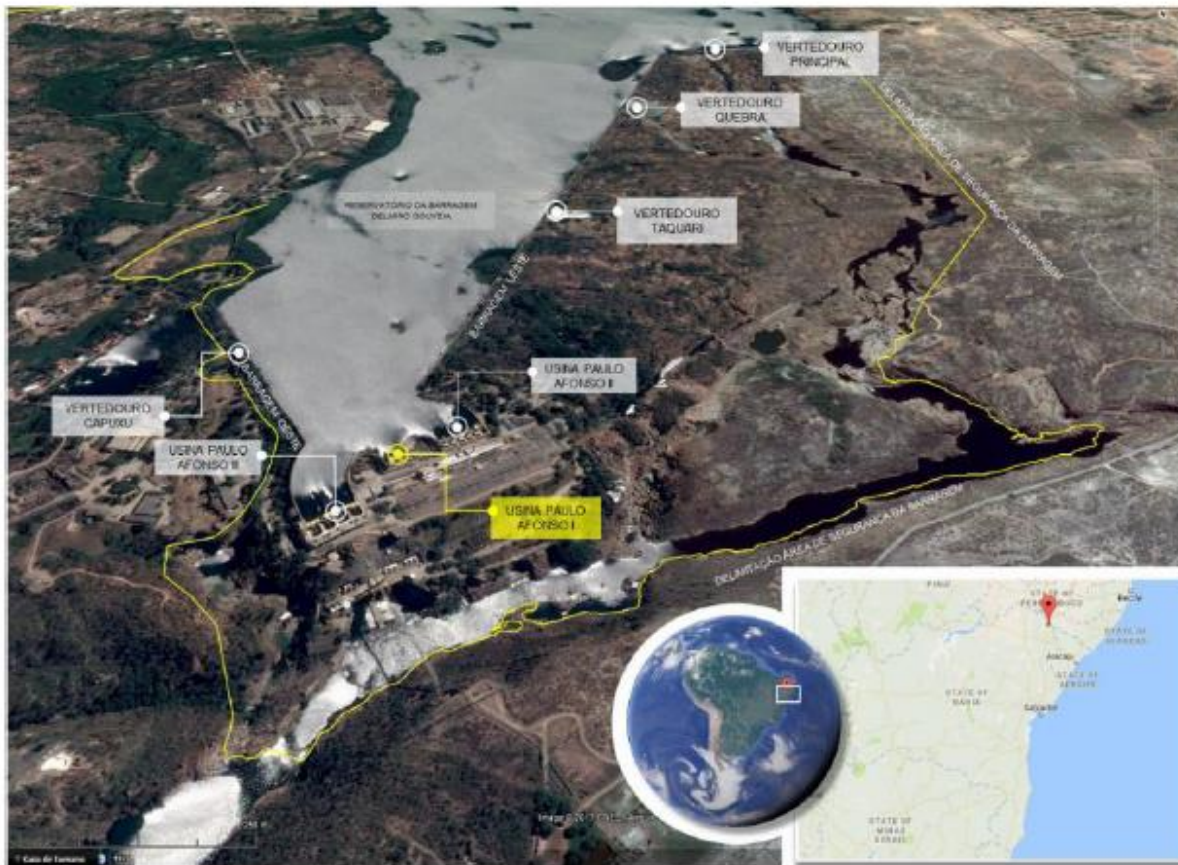
FIGURA 3.3 – ARRANJO GERAL DA USINA HIDRELÉTRICA PAULO AFONSO I
