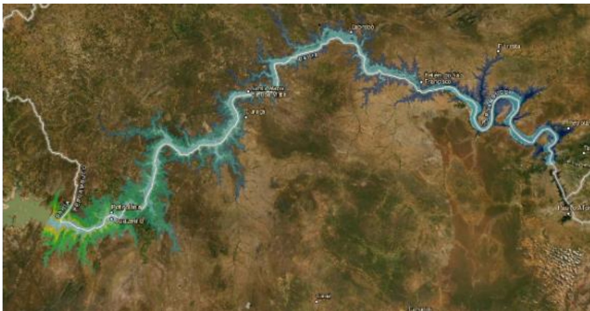
FIGURA 6.2 – IDENTIFICAÇÃO DA ZONA DE SEGURANÇA SECUNDÁRIA – ZSS
