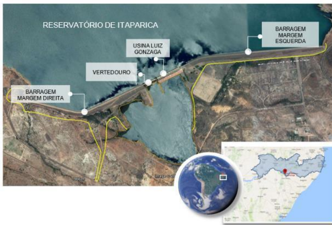
FIGURA 3.3 – ARRANJO GERAL DA USINA HIDRELÉTRICA LUIZ GONZAGA
