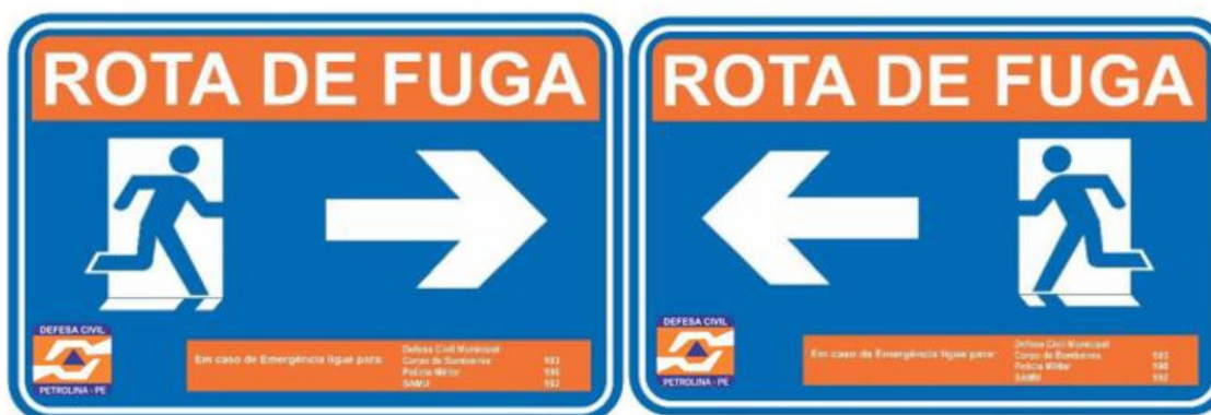
FIGURA 10.2 – PLACAS DE SINALIZAÇÃO DAS ROTAS DE FUGA NA ZAS DA UHE SOBRADINHO
