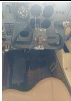
PT-SCE - COLUNA DE COMANDO - MANCHE - COPILOTO
