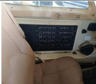
PT-SCE - PAINEL DE DISJUNTORES LADO ESQUERDO
